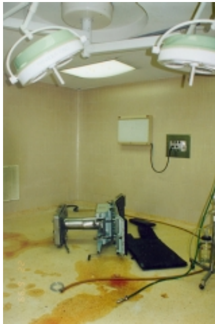
Figura 4.18 - Volcamiento de una mesa de cirugía
