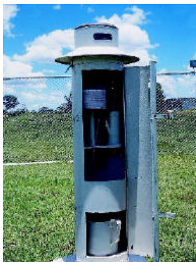
Fig. 6.2 Pluviógrafo común con un sistema de reloj
