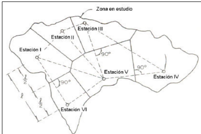
Fig. 6.12 Diagrama que explica el método de Thiessen
