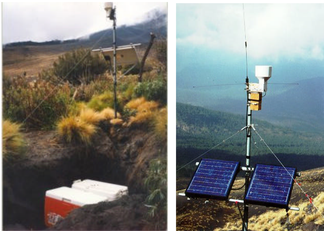
Fig. A.4. Aspectos de la instrumentación de las estaciones detectoras de flujos instaladas en el volcán Popocatépetl
