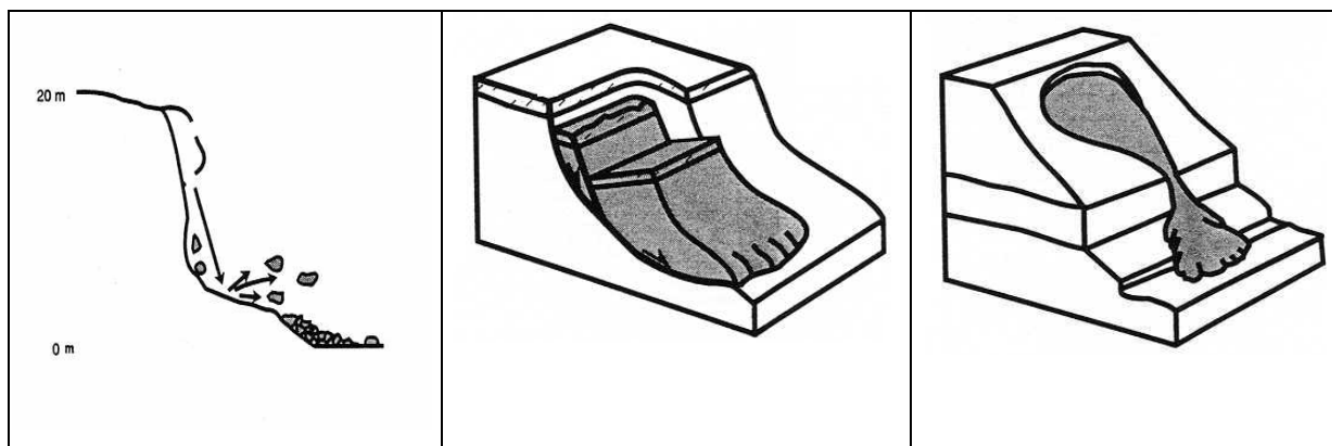
a) Caídos o derrumbes
