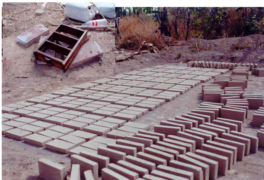
Figura 7.109 Elaboración de piezas de arcilla de 14 cm x 5 cm x 27 cm (ancho, alto, largo)
