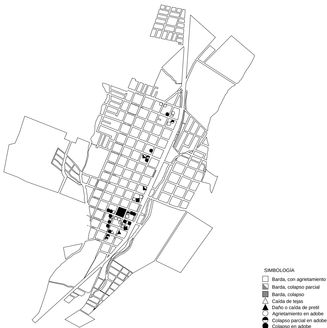
Figura 7.32 Localización de daños
