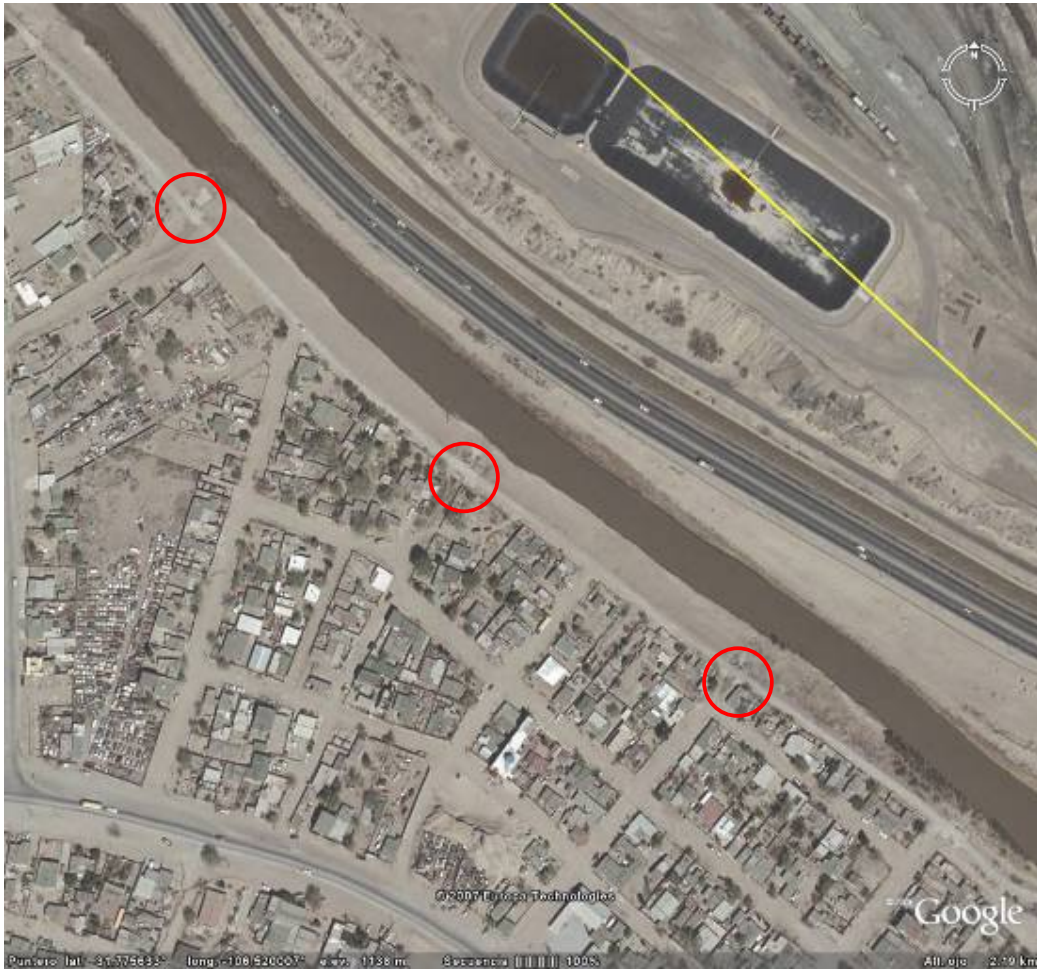
Figura 2.32 Compuertas ubicadas en la margen derecha (lado mexicano) del río Bravo, indicadas con círculos
