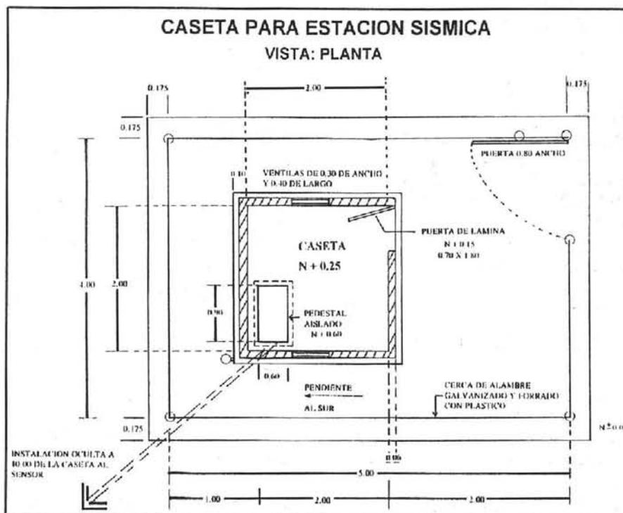
Figura 9b. Plano con la vista lateral de una caseta sismológica.
