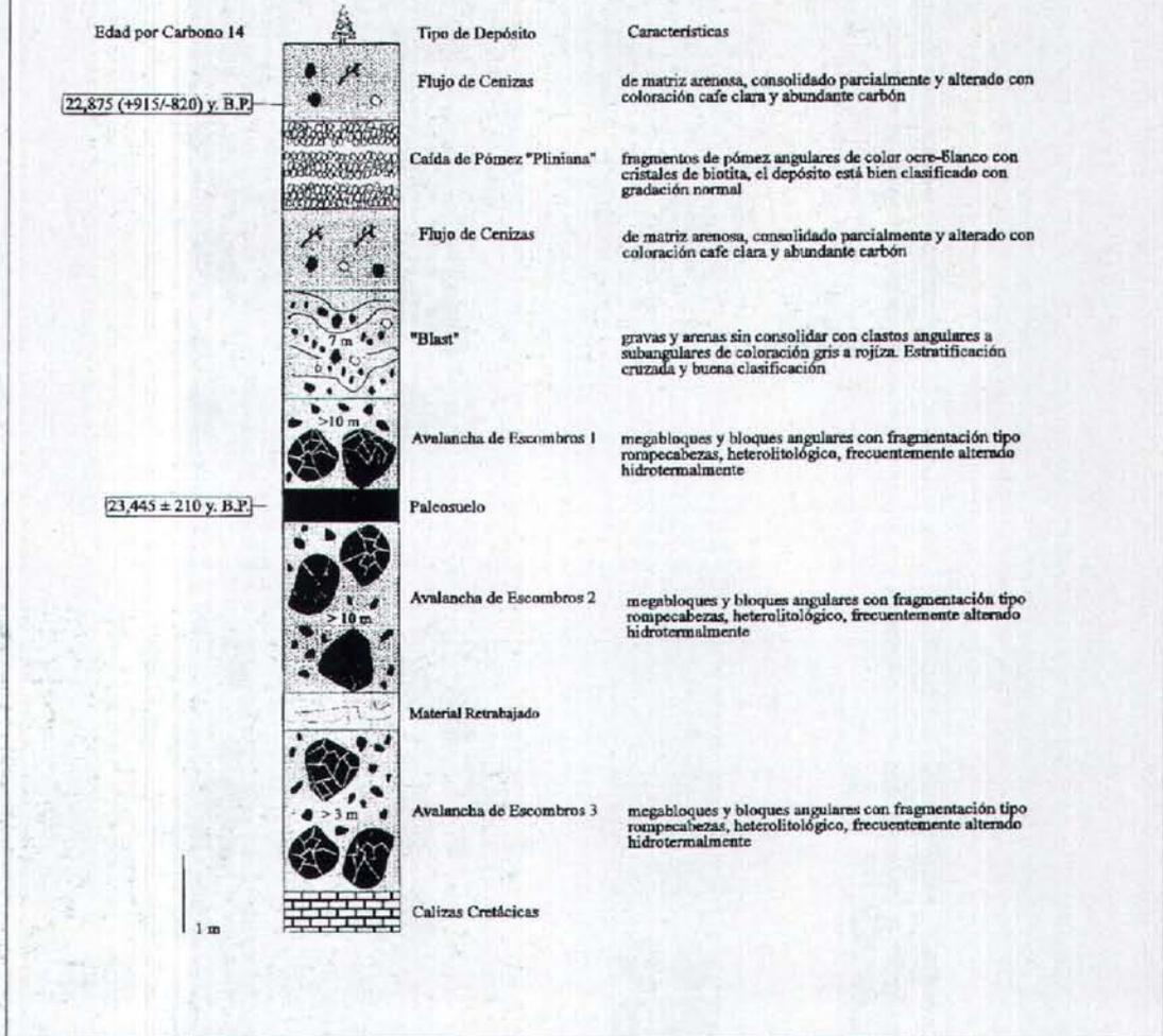
Fig. 17. Columna estratigráfica esquematizada que muestra la secuencia de los depósitos piroclásticos relacionados a las erupciones del tipo Santa Elena en el flanco sur del Popocatepetl. También se muestra la posición estratigráfica de las muestras de material orgánico fechadas por el método de radiocarbono 14.
