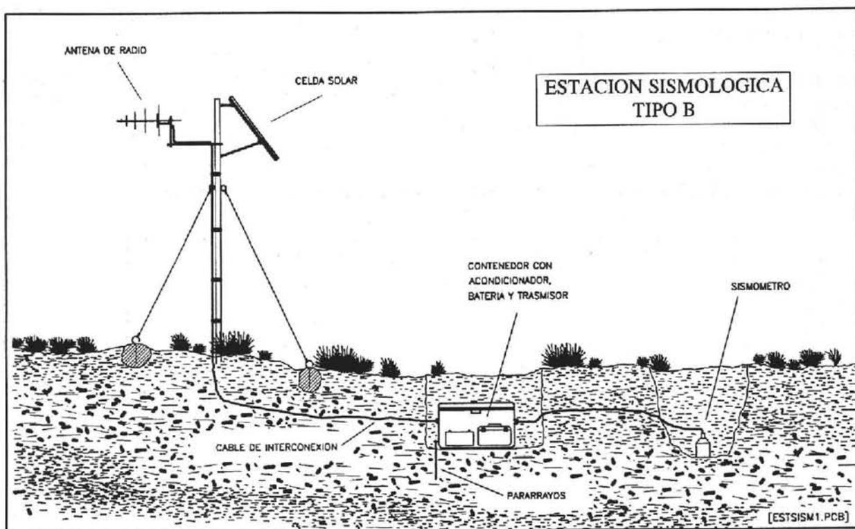
Figura 8. Esquema de la instalación y equipamiento de una estación sismológica tipo B sin caseta.
