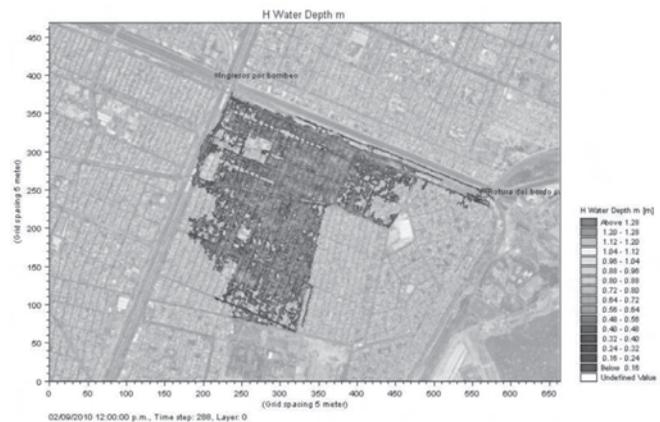
Simulación de la falla en el bordo derecho del río de los Remedios
