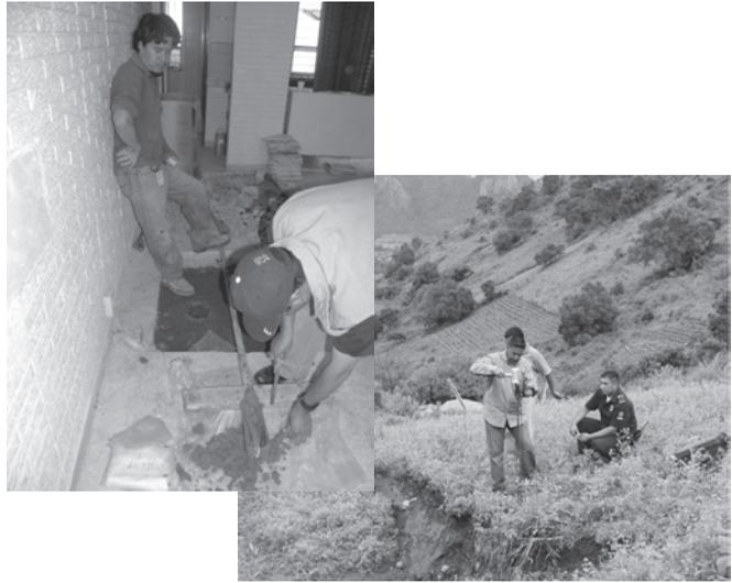
Equipos de campo portátiles para a) la obtención de muestras de suelo y b) la determinación de resistencias de los suelos con la profundidad
