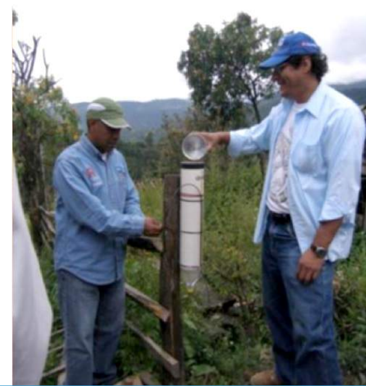
Colocación del pluviómetro casero en una zona libre de árboles y marquesinas
