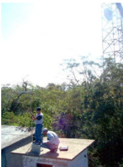
Pruebas de comunicación para definir los sitios donde se instalarán estaciones de medición de lluvia del Sistema de Alerta Hidrometeorológica del río Sabinal, en la ciudad de Tuxtla Gutiérrez, Chiapas.
