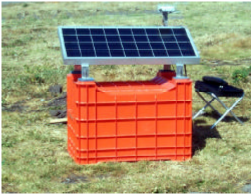
Estación sísmica portátil en el Valle de Toluca
