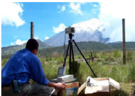
Medición de deformaciones en el volcán Popocatepetl
