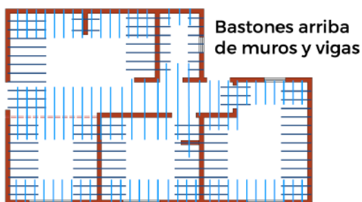
Parrillas en la parte baja
