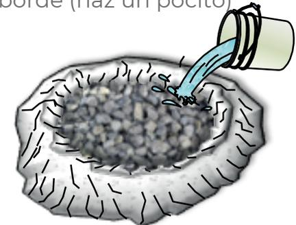
c) Agrega la grava y el agua, deja reposar 10 min y a revolver todo
