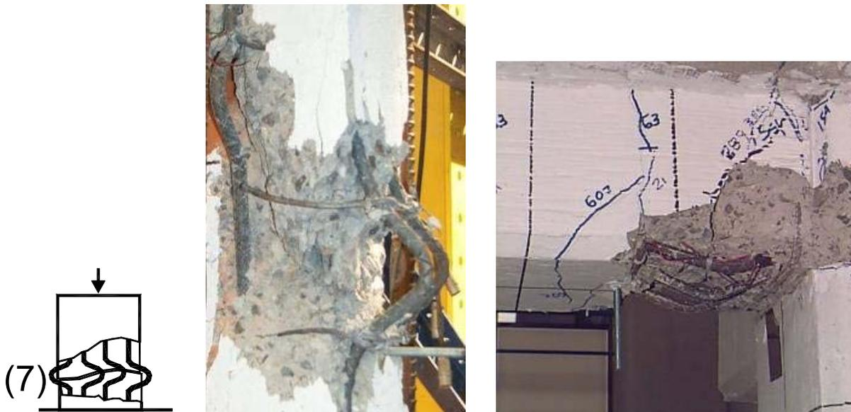
**Figura 3.83 Pandeo del refuerzo longitudinal:**
