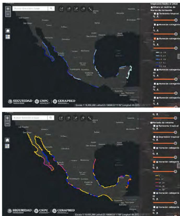
Figura 1. Altura de MT (izquierda) y periodos de retorno (derecha) para huracanes 2 ESS publicados en el ANR (elaboración propia)
