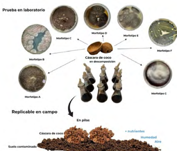
Imagen 3. Hongos aislados de cáscara de coco para su aplicación en tratamiento de suelo contaminado con hidrocarburos. Fuente: Cenapred
