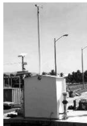
Fig. 50. Primer mareógrafo digital acústico mexicano. Manzanillo Colima, 1992. Fuente: CICESE
