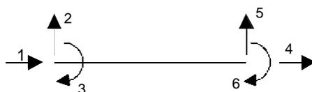
**Figura A.2** Numeración de los grados de libertad de una barra
